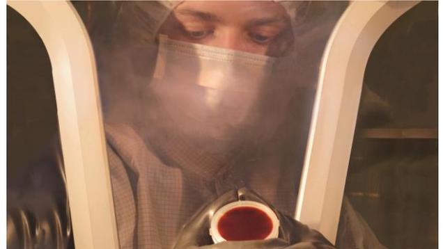
Hoch dotiertes GaN-Substrat mit 5 cm Durchmesser bei der Entnahme aus der Herstellungsanlage. (Quelle: Namlab gGmbH)
