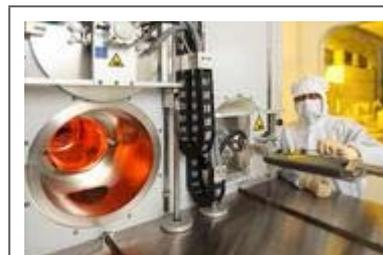
FuE-Reaktor am Fraunhofer IISB zur Herstellung von SiC-Epitaxieschichten
