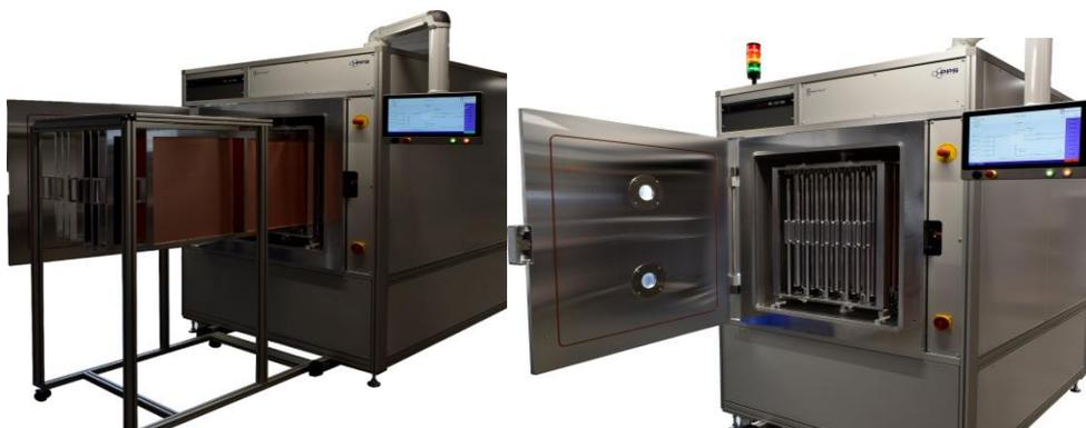
Unsere Kernkompetenz in der Lohnbeschichtung liegt in der Verarbeitung von Parylene. Dieses besondere Material wird mittels chemischer Gasphasenabscheidung als konforme Schicht auf jegliche Art von Substrat abgeschieden. Dabei setzen wir auf unsere selbst entwickelten Beschichtungs- und Plasmaanlagen, die weltweit zum Einsatz kommen.
