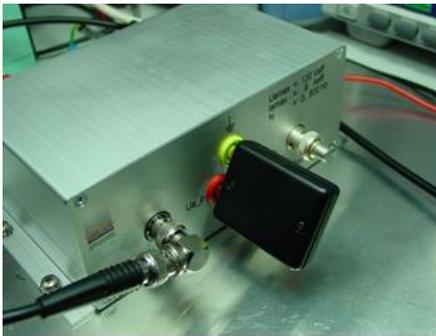
Mit Hilfe eines Signalgenerators lernen die Teilnehmer die Wirkungsweise und den Einfluss der Netznachbildung kennen. Außerdem wird die Korrelation eines Signals im Zeit- und Frequenzbereich veranschaulicht.
